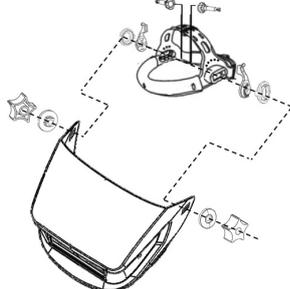
A. Gire la banda para la cabeza, primero, para asegurar que la perilla de ajuste de banda para la cabeza quede en la parte trasera, presione con la mano y gire la perilla de ajuste de diámetro de la banda hacia la izquierda, para ampliar el tamaño de la banda para la cabeza, o hacia la derecha, para reducirlo.
