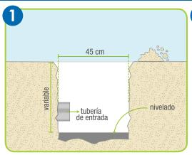
Proceda a excavar en el terreno un agujero de unos 45 cm de diámetro donde se ubique la **Caja** de **Registro Ecotank**<sup>®</sup>. El fondo del agujero debe nivelarse y debe estar libre de piedras que puedan dañar el fondo de la **CAJA**. La profundidad del agujero dependerá de que el **ACOPLE A** de la caja quede a nivel con la tubería de llegada principal del líquido.
