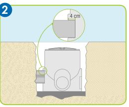
Coloque la **Caja de Registro Ecotank®** dentro la excavación e inserte a presión la tubería de llegada de líquido unos 4 cm dentro del **ACOPLE A** de la Caja.
