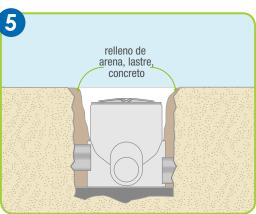
Coloque la tapa de inspección y proceda a rellenar los espacios alrededor de la **CAJA**. Preferiblemente utilice un material estéril: arena, lastre, concreto o similar.
