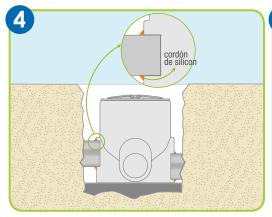
Para evitar posibles filtraciones, se recomienda colocar un cordón de sellador de silicón alrededor de las uniones entre tuberías y los **Acoples** de la **CAJA**.
