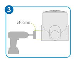
Proceda a remover las paredes de los acoples ciegos que desee interconectar en la **CAJA** con una Broca-sierra de 100 mm Ø.
