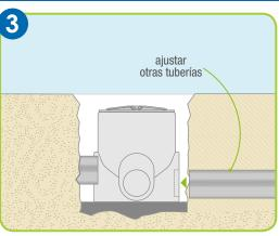
Conecte el resto de las tuberías según corresponda utilizando el mismo método.
