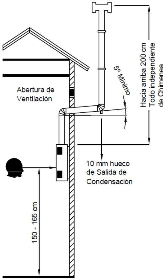
1. La unidad debe ser instalada de manera tal que la ventana de visión de flama, quede a la altura de los ojos de una persona (más o menos 1.50 a 1.65m sobre el nivel del piso)
